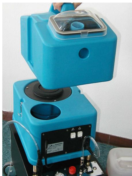
4. Kaltes oder lauwarmes Wasser durch die Befüllungsöffnung in den unteren Tank einfüllen, wobei ein Teil des Produktes T-FOAM pro 4 Teile Wasser hinzugefügt wird (wir empfehlen, nicht mehr als 2 Liter Produkt und 8 Liter Wasser zu nehmen).
