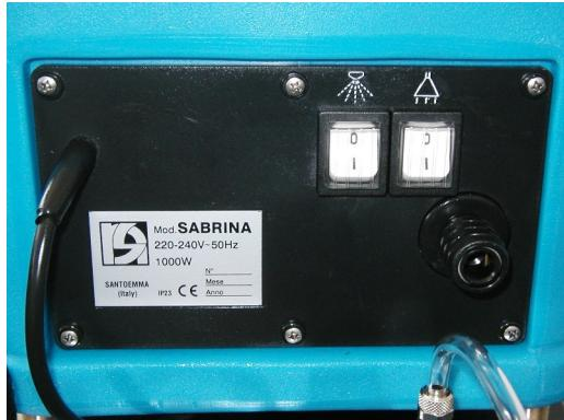
9. Allumer le compresseur, en agissant sur l'interrupteur qui se trouve sur le panneau du réglage de la mousse. De cette manière le compresseur se met en mouvement et la pression dans le réservoir de l'air comprimé commence à augmenter. Dans cette phase l'aiguille du manomètre, qui indique la pression de l'air, se déplace vers des niveaux de pression plus élevés.
