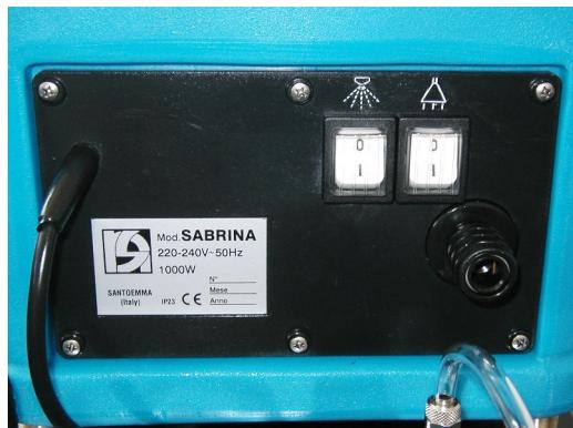
9. Ponga en marcha el compresor actuando en el interruptor que se encuentra en el cuadro de regulación de la espuma. De esta manera el compresor se pone en marcha y la presión en el tanque del aire comprimido empieza a subir. En esta fase la aguja del manómetro que indica la presión del aire se mueve hacia niveles de presión más altos.
