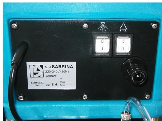
9. Accendere il compressore, agendo sull'interruttore che si trova sul pannello della regolazione della schiuma. In questo modo il compressore si mette in moto e la pressione nel serbatoio dell'aria compressa inizia ad aumentare. In questa fase la lancetta del manometro che indica la pressione dell'aria si muove verso livelli di pressione più alti.
