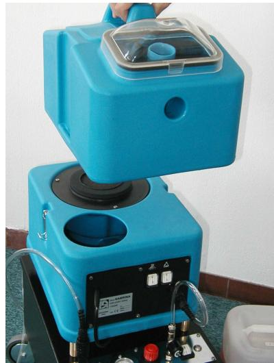
4. Mettre de l'eau froide ou tiède dans le réservoir inférieur à travers le trou de chargement, en ajoutant une partie de produit T-FOAM pour toutes les 4 parties d'eau (nous conseillons de ne pas mettre plus de 2 litres de produit et 8 litres d'eau).
