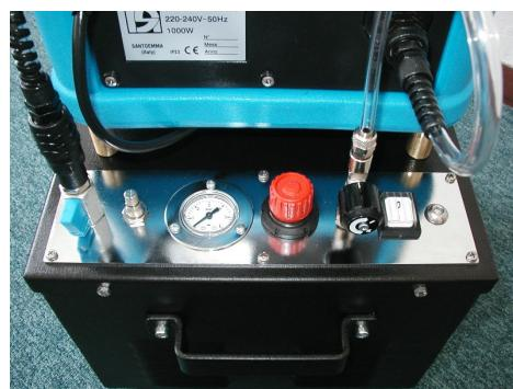
10. Ungefähr 1 Minute warten, ohne mit dem Hebel der Lanze zu sprühen, bis der Druck im Lufttank auf ein Niveau ansteigt, auf dem sich der Kompressor ausschaltet. Die während der Endabnahmephase durchgeführte Kalibrierung der Maschine sieht vor, dass der Druck unter diesen Bedingungen circa 4 bar beträgt.
