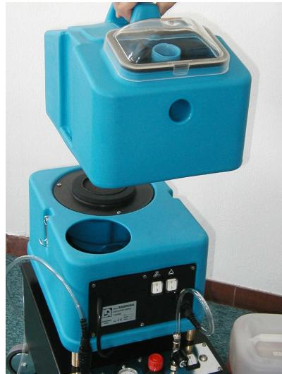
4. Vierta agua fría o tibia en el tanque inferior a través de la abertura de carga, añadiendo una parte de producto T-FOAM, por cada 4 partes de agua (aconsejamos no poner más de 2 litros de producto y 8 litros de agua).
