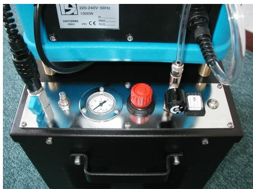
10. Attendre environ 1 minute, sans vaporiser avec le levier de la lance, jusqu'à quand la pression du réservoir de l'air augmente à un niveau tel que le compresseur s'éteint. L'étalonnage de la machine fait en phase de réception prévoit que dans ces conditions la pression soit d'environ 4 bars.
