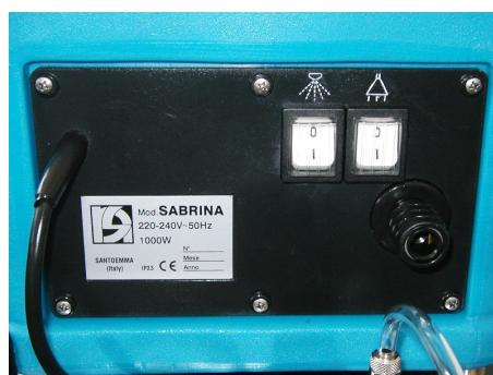
9. Den Kompressor durch Betätigung des Schalters einschalten, der sich auf der Bedienblende der Schaumregulierung befindet. Auf diese Weise setzt sich der Kompressor in Gang und der Druck im Luftdrucktank beginnt zu steigen. In dieser Phase bewegt sich der Zeiger des Manometers, der den Luftdruck anzeigt, in Richtung des höchsten Druckniveaus.
