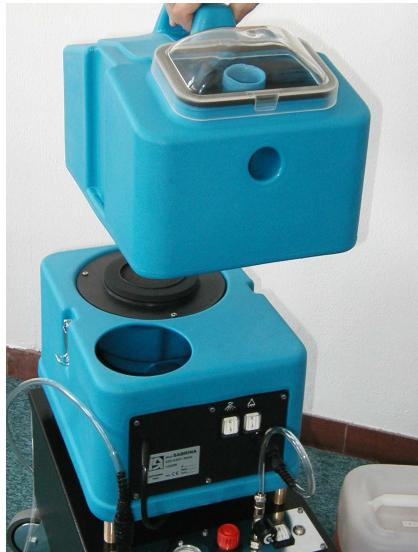
4. Mettere acqua fredda o tiepida nel serbatoio inferiore attraverso il foro di carico, aggiungendo una parte di prodotto T-FOAM per ogni 4 parti di acqua (consigliamo di non mettere più di 2 litri di prodotto e 8 litri di acqua).
